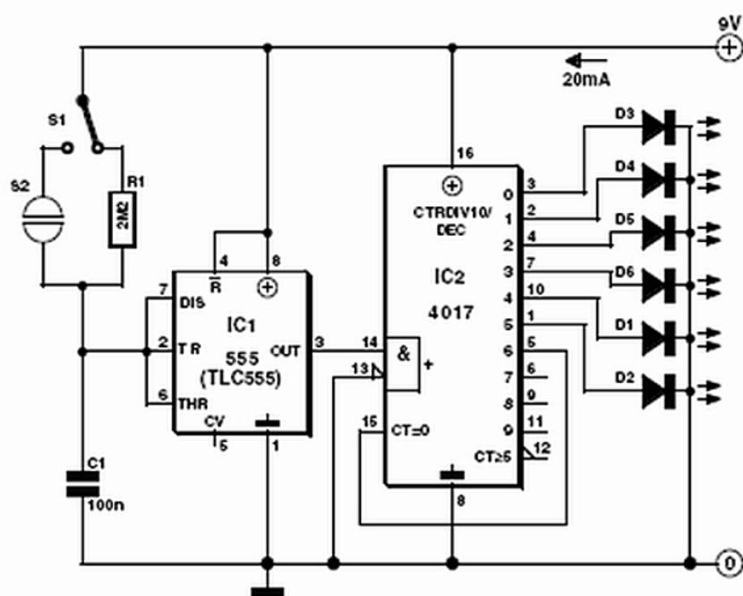
comporte une paire de circuits intégrés, une résistance, un condensateur et 7 LED. Le compteur décimal, IC2, un 4017, produit une illumination successive des LED. Le rythme de ce défilement dépend du signal d'horloge appliqué à sa broche 14, signal d'horloge fourni par IC1, un temporisateur du type 555 monté en multivibrateur astable. Les valeurs attribuées à R1 et C1 déterminent la fréquence d'horloge.
