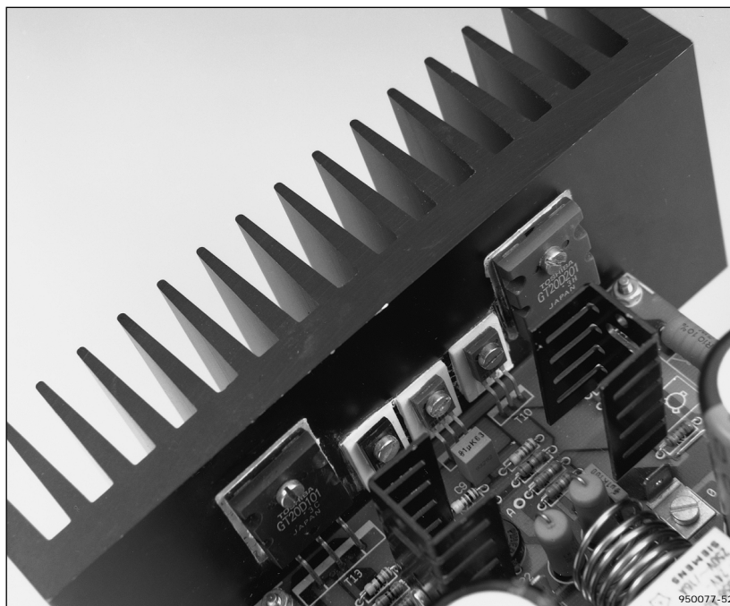
Figure 4. Il est vital, pour garantir une stabilité thermique correcte, d'établir un bon couplage avec le radiateur.
