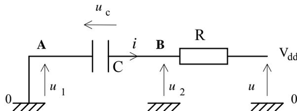
Le condensateur se charge suivant la loi :  $u_c = a + b e^{-t'/RC}$
