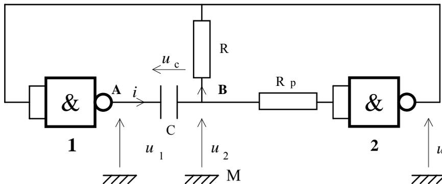
**N.B.** la résistance  $R_p$ , suffisamment élevée, permet de négliger le courant d'entrée du second inverseur devant celui qui traverse le circuit RC, particulièrement lorsque  $u_2 < 0$  ou  $u_2 > V_{dd}$ .
