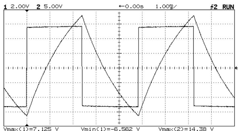
Le condensateur se charge à travers la résistance R et la tension  $u_c$  varie entre  $V_B$  et  $V_H$  en suivant une loi de la forme  $u_c = a + b e^{-t/RC}$  ; où a et b dépendent des conditions initiales.
