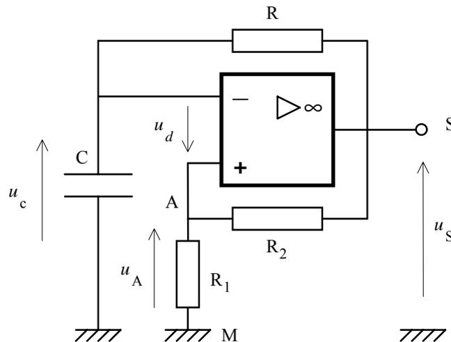
L'amplificateur opérationnel fonctionne en régime de *saturation* :
