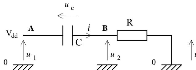
Le condensateur se charge suivant la loi :  $u_c = V_{dd} (1 - e^{-t/RC})$ ,  $u_c$  tend vers  $+V_{dd}$ .
