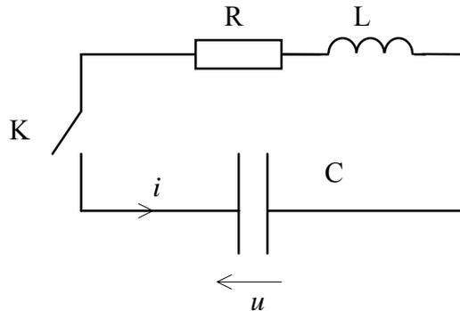
Le condensateur initialement chargé sous tension constante  $u = U_0$  a donc accumulé l'énergie électrostatique  $W = \frac{1}{2}CU_0^2$ . Lorsque l'on ferme l'interrupteur K, il y a **échange d'énergie** entre le condensateur et la bobine et **dissipation d'énergie** dans la résistance R.
