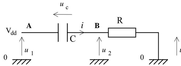
Même circuit de charge que le premier état, mais avec des conditions initiales différentes. Le condensateur se charge suivant la loi :  $u_c = a + b e^{-t''/RC}$
