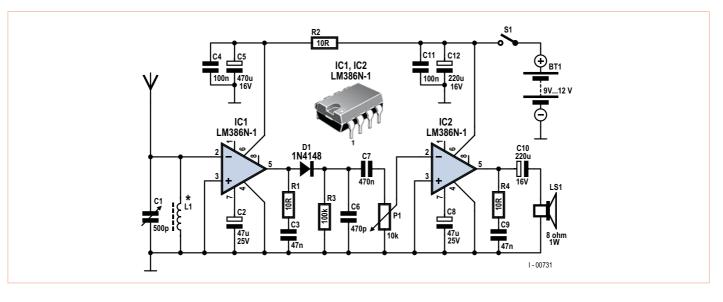
L'amplificateur LM386N existe en quatre versions différentes (LM386N-1, -2, -3 et -4). Les versions -1 et -3 conviennent mieux pour IC1. Pour le choix d'IC2, en règle générale plus le chiffre est élevé, plus le volume sonore du haut-parleur est important. Nous recommandons -3 pour une alimentation de 9 V parce que ce circuit peut délivrer une puissance d'environ 0,7 W à un haut-parleur de 8  $\Omega$ .
