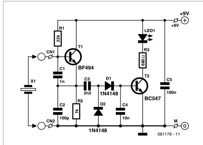
pastillée de câblage rapide. Dans les deux cas, le matériau support devra impérativement être du verre époxy et non de la bakélite en raison des fréquences élevées pouvant être mises en jeu.
